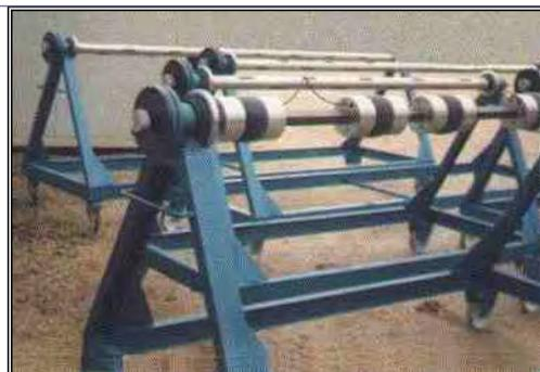
Lève Bobine Mécano-Pneumatique ou Mécanique
