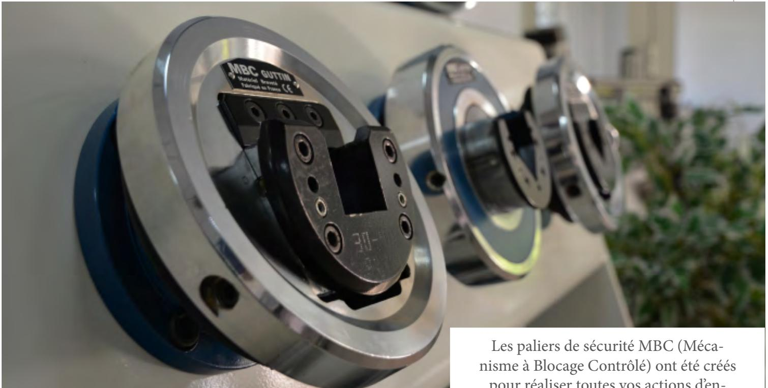
Les paliers de sécurité MBC (Mécanisme à Blocage Contrôlé) ont été créés pour réaliser toutes vos actions d'enroulage et de déroulage. Son système de verrouillage automatique vous protège de tout incident. Votre sécurité est le plus important pour nous ! Découvrez toutes nos conceptions et trouvez la solution la plus adaptée à vos besoins pour votre installation.
